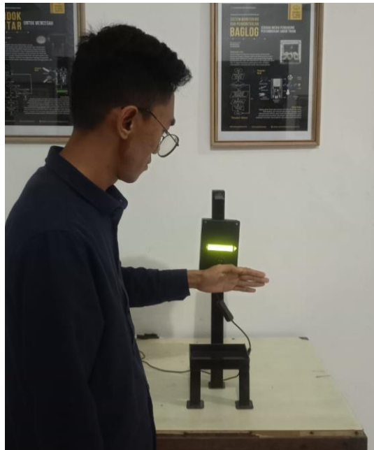
Gambar 6. Pengujian perangkat keras pengukuran suhu tubuh
