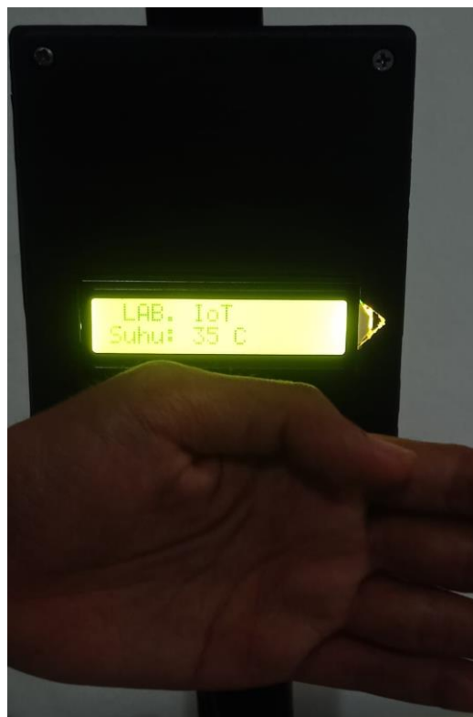
Gambar 7. Hasil pengujian perangkat keras pengukuran suhu tubuh
